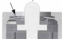
Пружина Беллвиля сработала
