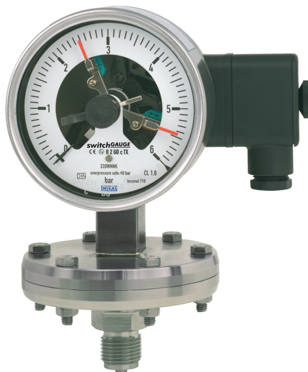
Мембранный манометр с переключающими контактами, модель 432.56.100, допустимая перегрузка до 40 бар с переключающим контактом модели 831.21
