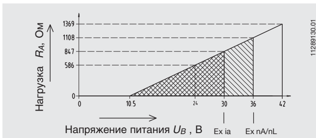
Диаграмма нагрузки. Допустимая нагрузка в зависимости от напряжения питания.
