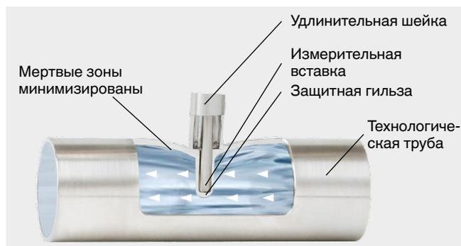
Запатентованная гигиеническая конструкция проточного корпуса TW61 позволяет минимизировать мертвые зоны и обеспечивает гибкость монтажа благодаря функции самодренаживания.
