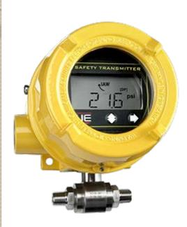
Дискретные выходы обеспечивают надежное и быстрое (3мс) аварийное отключение при обнаружении неисправности. Уставки и гистерезис являются 100% программируемыми. Полезный срок службы датчика серии One для систем безопасности составляет 50 лет.
