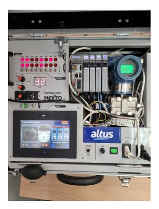
Контроллеры ALTUS могут иметь резервированные центральные процессоры, коммуникационные интерфейсы и модули ввода/вывода.
